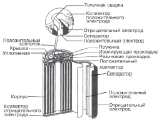
Структура цилиндрического Li-ИА
